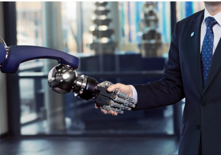
Päťprstová uchopovacia ruka SCHUNK SVH je prvá DGUV certifikovaná uchopovacia ruka na svete pre kolaboratívnu prevádzku.
