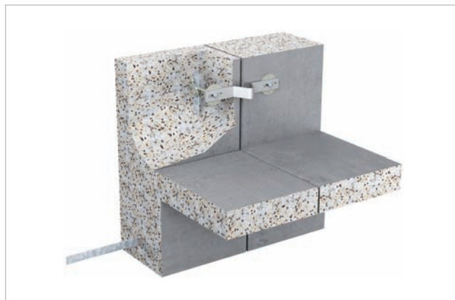
Obr. 5 Príklad riešenia dilatácie
